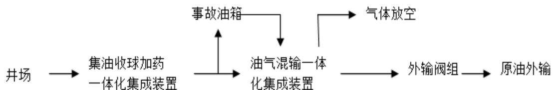
图 4-2 站场集输工艺流程及产污环节图
