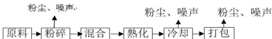
图 4.1-7 饲料加工生产工艺流程及排污节点
