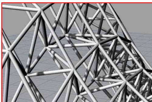
图3 钢管相贯连接图
