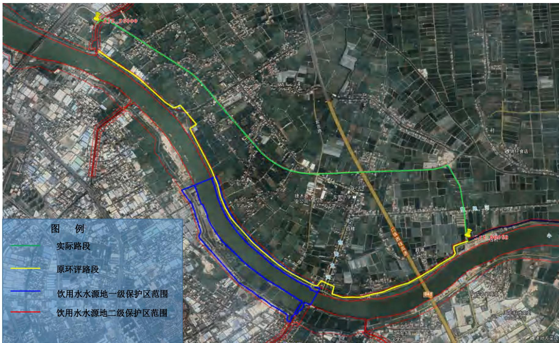
图 6 DG000~DG058 管段路由变化图及与水源保护区的关系
