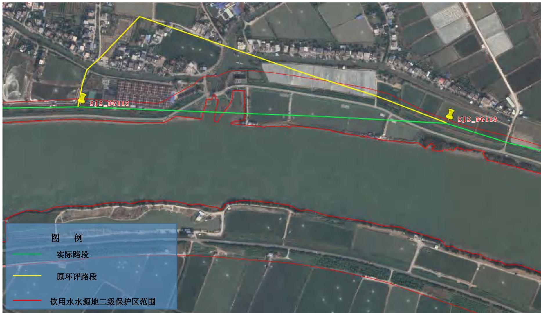
附图 8 DG0112~DG0113 管段路由变化图及与水源保护区的关系
