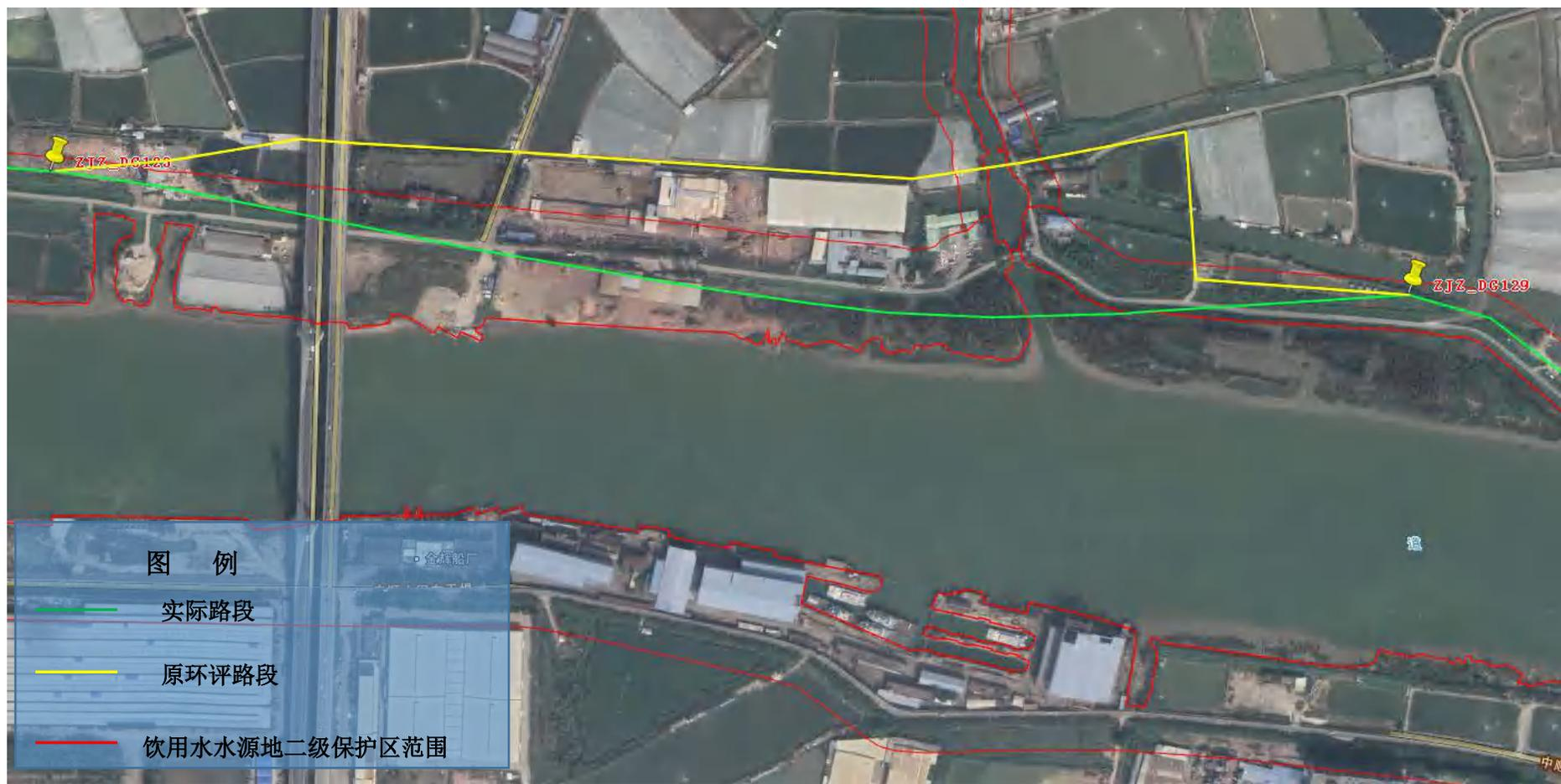
附图9 DG123~ZJZ\_DG129 管段路由变化图及与水源保护区的关系
