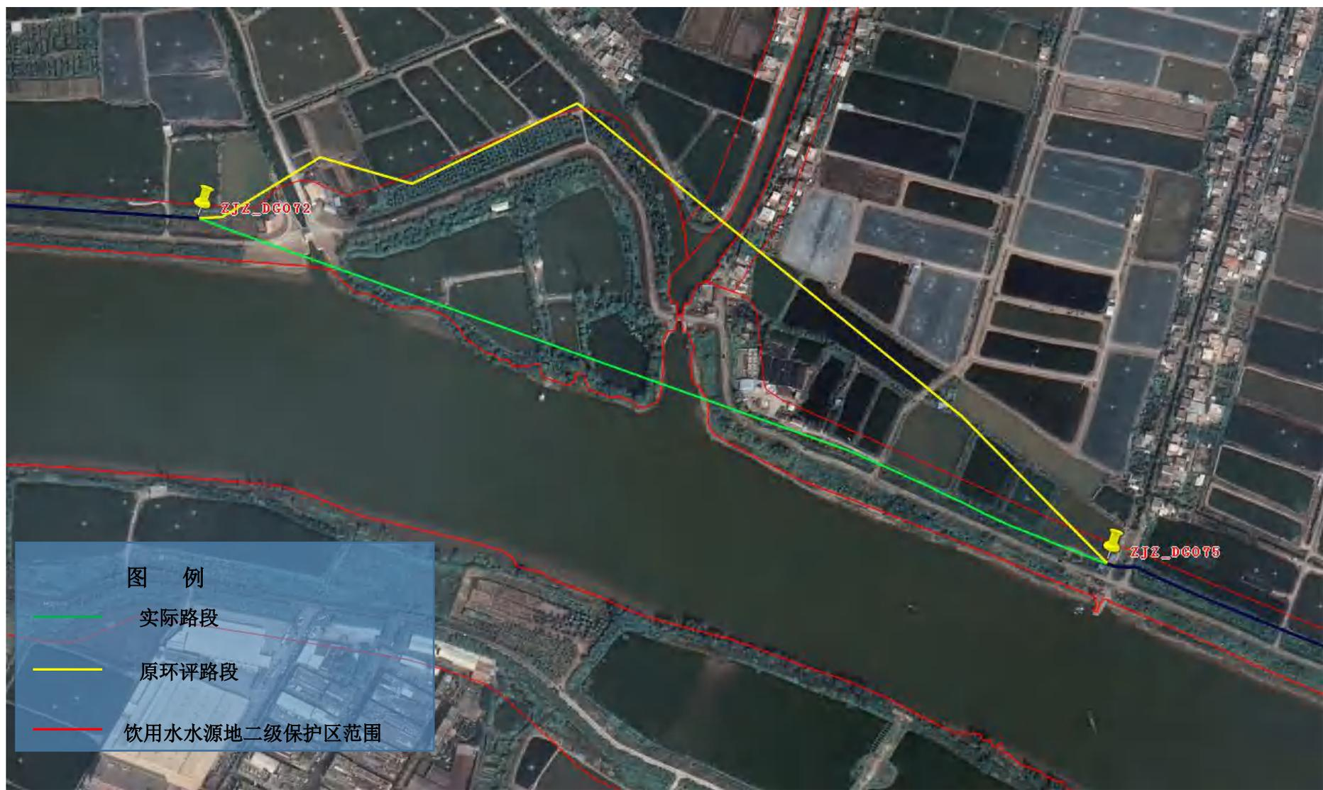
附图 7 DG072~ DG075 管段路由变化图及与水源保护区的关系
