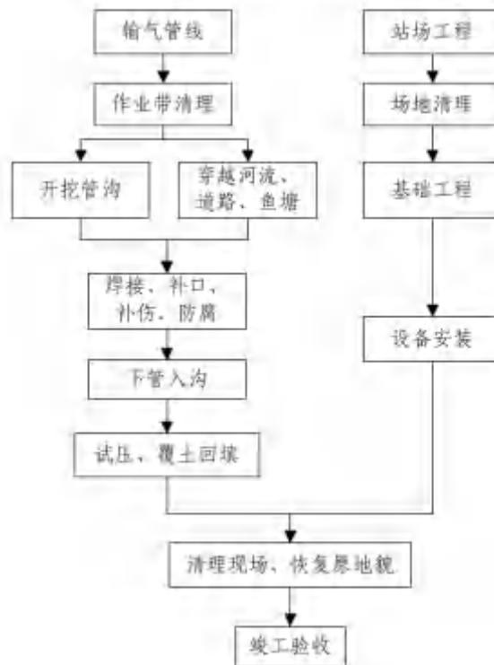
图2.4-1 项目施工工艺流程图
