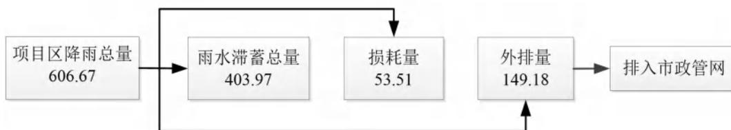
图 3.5-1 项目区水量平衡图
